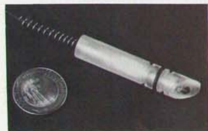
La microsonda a fibra ottica del nuovo Laser Doppler Velocimetro Distribuito. La sonda è inseribile nella parte del condotto idraulico sotto misura.
