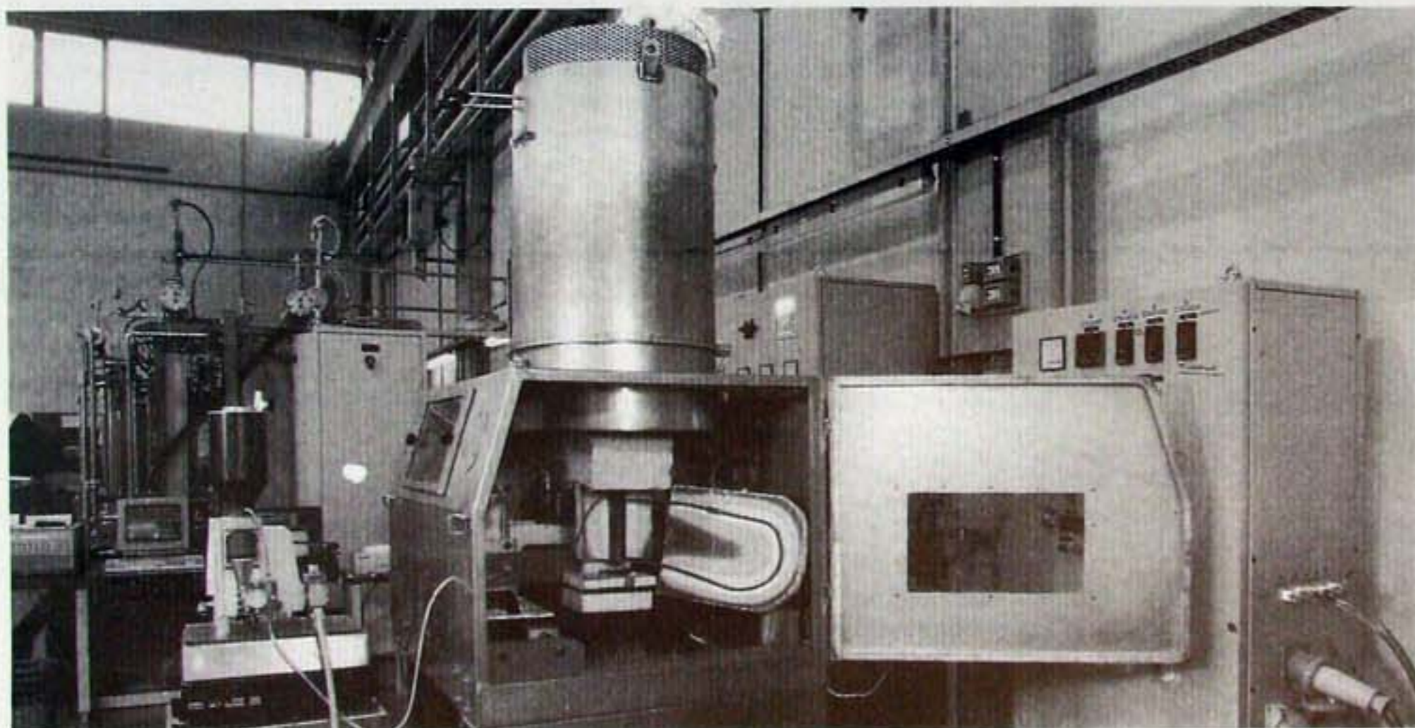
Dispositivo per prove di erosione da particelle solide a caldo, per la simulazione di fenomeni di erosione in letti fluidi.
