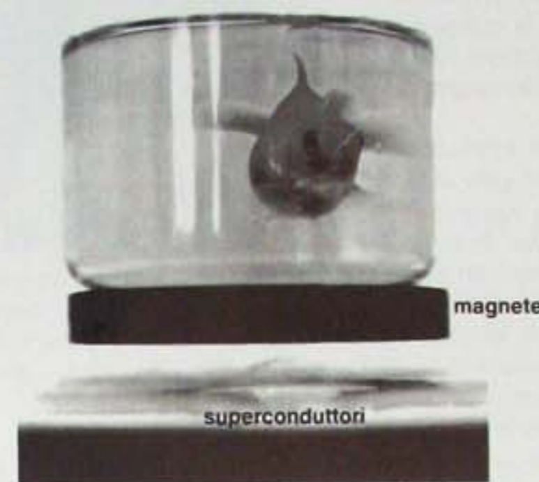
Levitazione di un magnete permanente sopra una superficie superconduttiva ceramica.
