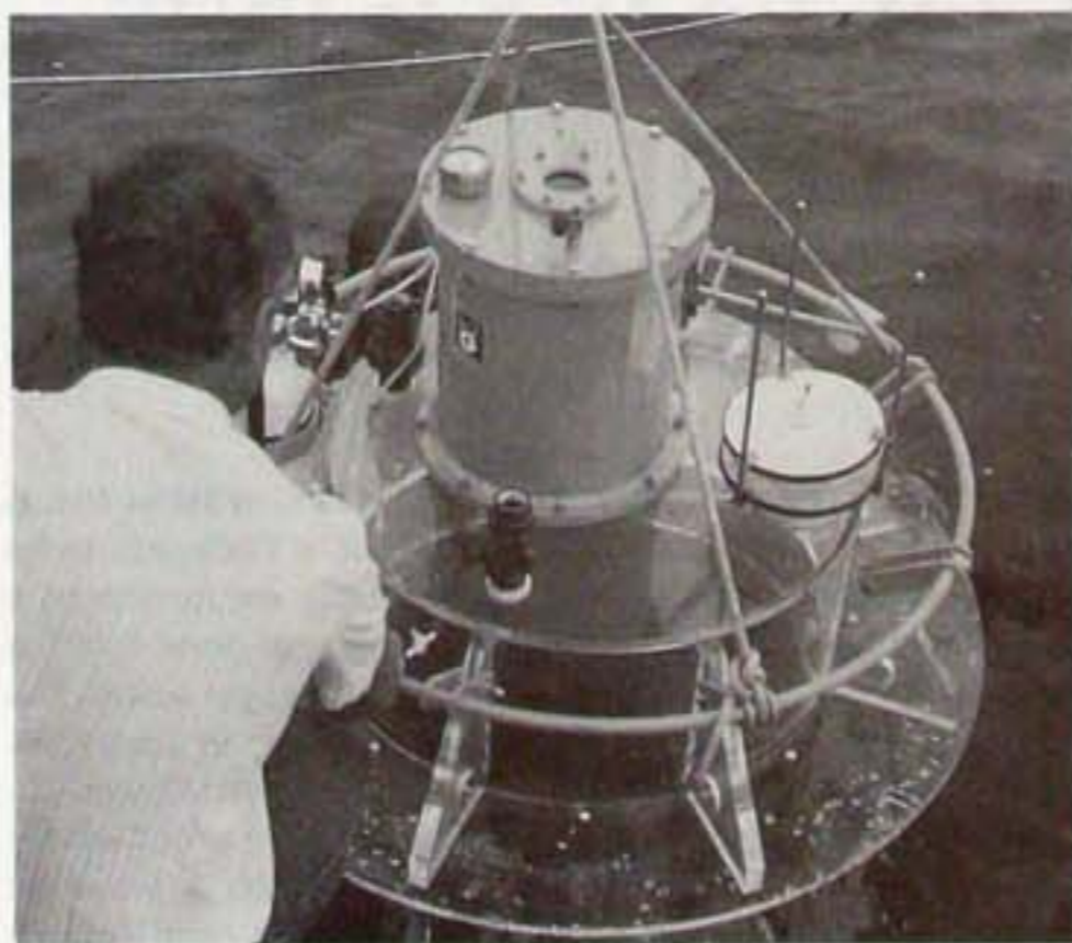
Camera bentica, per lo studio in campo del rilascio di sostanze da sedimenti.
